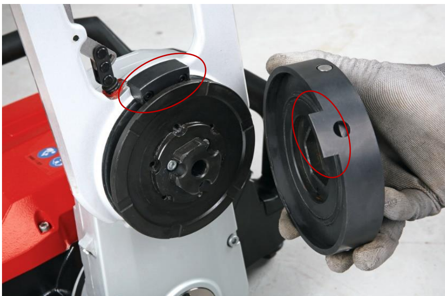
Figura 4: Blocco di sicurezza sulla testa di taglio e sulla flangia raso parete
