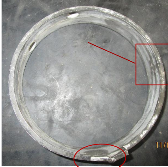
Figura 7: Anelli danneggiati con blocco di sicurezza rotto e spinotti mancanti.
