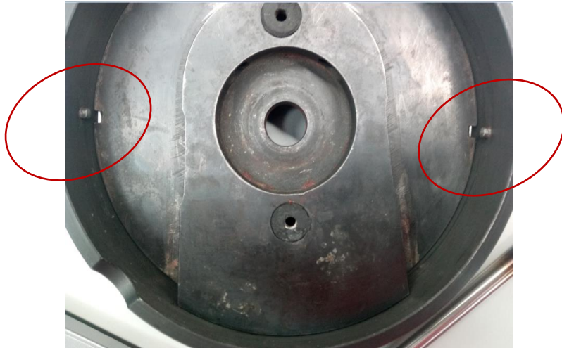
Figura 5: Gli spinotti garantiscono il movimento lineare degli anelli e tengono gli anelli in posizione durante l'operazione. Se uno o entrambi gli spinotti sono danneggiati, il funzionamento non è più garantito.
