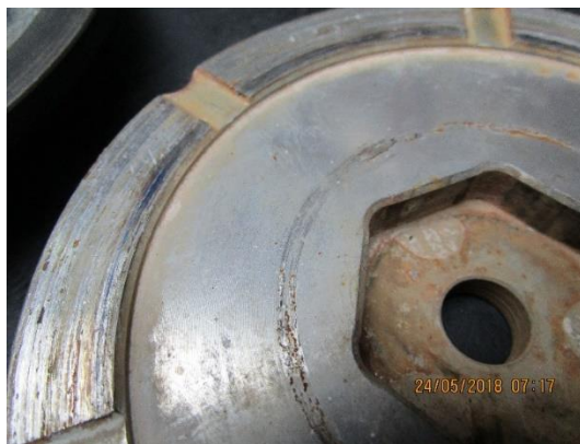
Figura 3: Flangia con diametro esterno consumato
