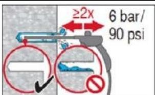
Soffiare 2 volte dal retro del foro (se necessario, con prolunga ugello) per tutta la lunghezza del foro con aria compressa priva di olio (min. 6 bar a  $6 \text{ m}^3/\text{h}$ ) fino a quando il flusso d'aria di ritorno sia privo di polvere osservabile e acqua.
