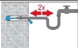
Pulire il foro con un getto d'acqua per 2 volte inserendo un tubo dell'acqua (pressione linea acqua) nel retro del foro fino a quando l'acqua esce pulita.
