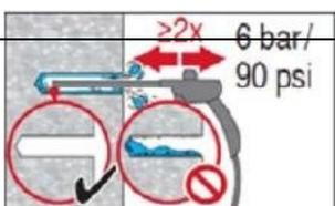
Soffiare nuovamente con aria compressa per 2 volte finché il flusso d'aria di ritorno sarà privo di polvere visibile e acqua.
