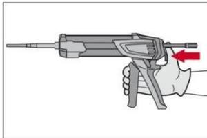
Al termine dell'iniezione, depressurizzare il dispenser premendo l'apposito grilletto. Ciò previene l'ulteriore erogazione di adesivo dal miscelatore.
