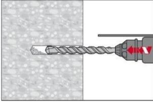
Praticare il foro alla profondità di ancoraggio necessaria con un trapano a percussione impostato sulla modalità rotazione usando una punta in carburo di dimensioni adeguate.
