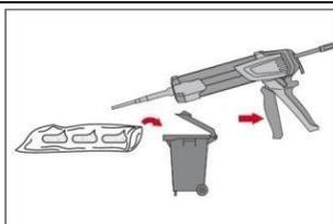
La cartuccia si apre automaticamente all'inizio dell'erogazione. Eliminare l'adesivo iniziale. In base al formato della cartuccia occorre eliminare una quantità iniziale di adesivo.
