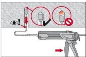
Installazione a soffitto e/o installazione con profondità di ancoraggio  $h_{ef} > 250\text{mm}$ . Per l'installazione a soffitto, l'iniezione è possibile solamente con l'ausilio di estensioni e perni d'arresto. Assemblare il miscelatore HIT-RE-M, le estensioni e un perno d'arresto HIT-SZ di dimensioni adeguate. Inserire il perno d'arresto nel retro del foro e iniettare l'adesivo. Durante l'iniezione, il perno d'arresto viene naturalmente espulso dal foro dalla pressione dell'adesivo.
