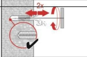
Spazzolare 2 volte con lo scovolino del formato indicato inserendo lo scovolino d'acciaio Hilti HIT-RB nel retro del foro (se necessario, con la prolunga) con un movimento di torsione e rimuovendolo. Lo scovolino deve produrre una naturale resistenza entrando nel foro - in caso contrario, lo scovolino è troppo piccolo e deve essere sostituito con uno di diametro adeguato.
