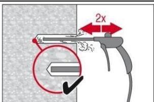
Soffiare 2 volte dal retro del foro (se necessario, con prolunga ugello) per tutta la lunghezza del foro con aria compressa priva di olio (min. 6 bar a  $6\text{ m}^3/\text{h}$ ) fino a quando il flusso d'aria di ritorno sarà privo di polvere osservabile.
