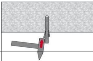
Per l'installazione a soffitto, usare i perni d'arresto e fissare le parti integrate, ad es. mediante cunei HIT-OHW.
