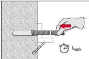
Prima dell'uso, verificare che l'elemento sia asciutto e privo di olio e altri contaminanti. Contrassegnare e posare l'elemento alla profondità di ancoraggio necessaria fino al trascorrere del tempo di lavorazione  $t_{work}$  ..
