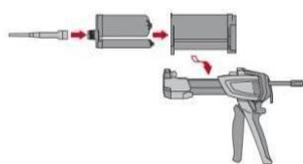
Fissare saldamente l'ugello di miscelazione HIT-RE-M al collettore della cartuccia (montaggio aderente). Non modificare l'ugello di miscelazione. Attenersi alle istruzioni per l'uso del dispenser e della resina. Controllare il corretto funzionamento del supporto cartuccia. Non usare cartucce / supporti danneggiati. Inserire la cartuccia nel supporto e inserire il supporto nel dispenser HIT.
