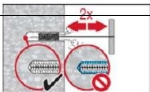
Spazzolare 2 volte con lo scovolino del formato indicato inserendo lo scovolino d'acciaio Hilti HIT-RB nel retro del foro (se necessario, con la prolunga) con un movimento di torsione e rimuovendolo. Lo scovolino deve produrre una naturale resistenza entrando nel foro - in caso contrario, lo scovolino è troppo piccolo e deve essere sostituito con uno di diametro adeguato.
