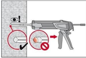
Iniettare l'adesivo partendo dal retro del foro, ritirando lentamente il miscelatore a ogni pressione del grilletto. Riempire i fori per circa 2/3. Ciò è necessario per garantire che l'intercapedine anulare tra l'ancorante e il calcestruzzo sia completamente piena di adesivo lungo la lunghezza di ancoraggio.
