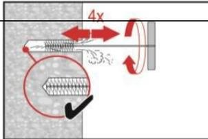
Spazzolare 4 volte con lo scovolino del formato indicato (diametro scovolino  $\geq$  foro) inserendo lo scovolino d'acciaio Hilti HIT-RB nel retro del foro (se necessario, con la prolunga) con un movimento di torsione e rimuovendolo. Lo scovolino deve produrre una naturale resistenza entrando nel foro - in caso contrario, lo scovolino è troppo piccolo e deve essere sostituito con uno di diametro adeguato.
