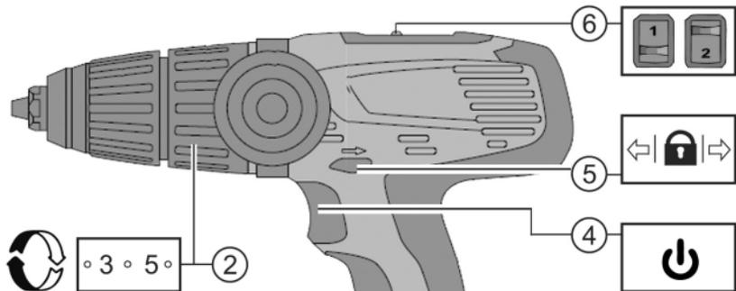
◀ اختر السرعة المرغوبة من خلال ضبط مفتاحي اختيار السرعة.
