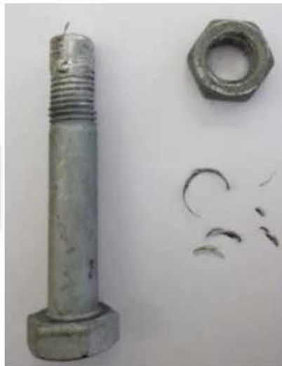
HV Bolt failure
