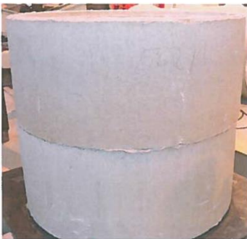
Immagini 3 e 4: Vista degli anelli del pozzetto assemblati con la schiuma fuoriuscita all'esterno e all'interno
