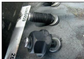
X-BT-MF piegato nel test interno
