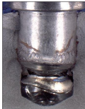
Effetto di pinzatura e saldatura del materiale base sullo stelo dell'X-BT-MF
